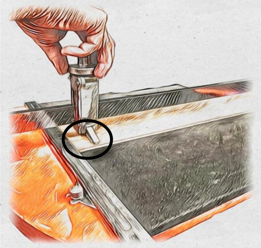
**3** Ubicamos el tronzador en uno de los extremos de la barra de acero, de modo que su arco flotante inferior se apoye sobre la pieza, a unos 3 cm de la regla.
