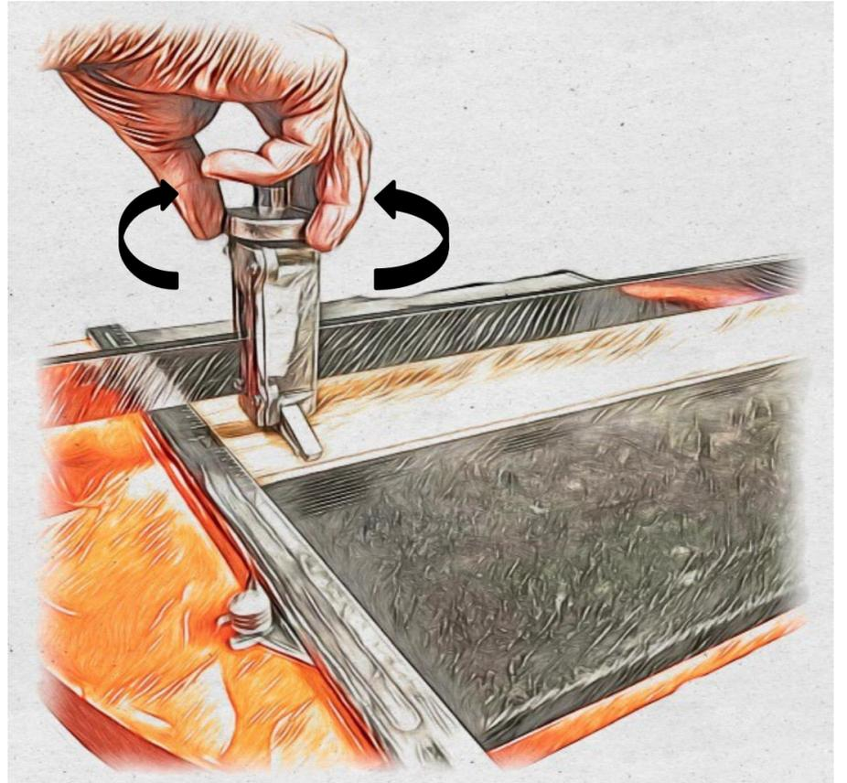
**4** Regulando el tronzador, aumentamos la presión sobre la pieza hasta logra la apertura correspondiente del corte.
