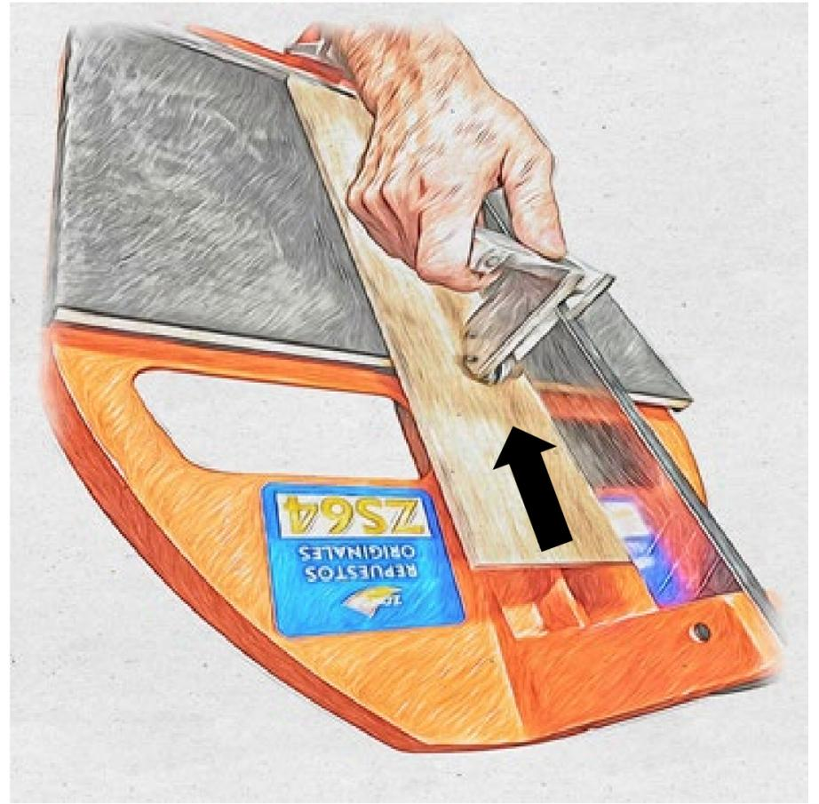
**2** Manteniendo esa presión constante, desplazamos el trazador hacia nosotros, produciendo una marca.
