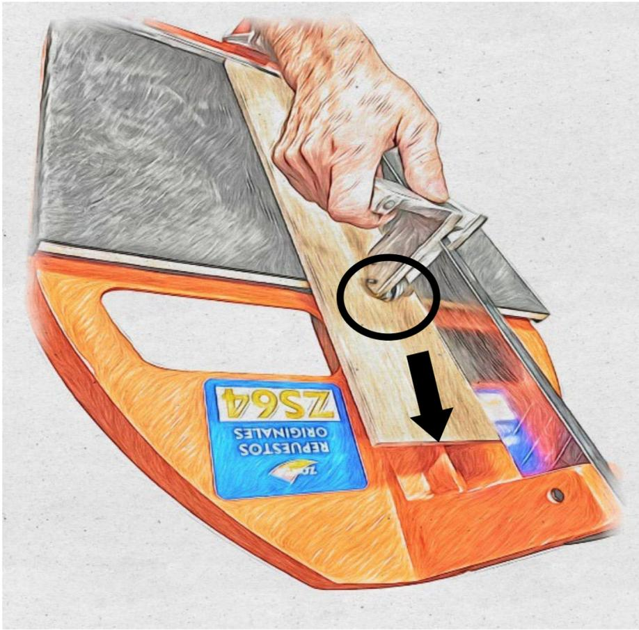
**1** Ubicamos la rueda de corte sobre el borde mas lejano de la pieza, presionando hacia abajo el trazador, y de forma constante y moderada ejercemos presión.
